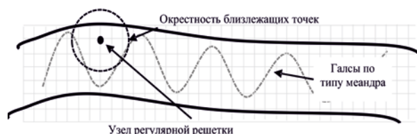
Рисунок 2. Схематичное представление проблемы занижения реального значения глубины при движении судна галсами по типу меандра на реках и других водотоках
