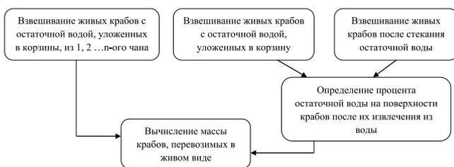
**Рисунок 4.** Алгоритм определения массы живых крабов весовым методом
