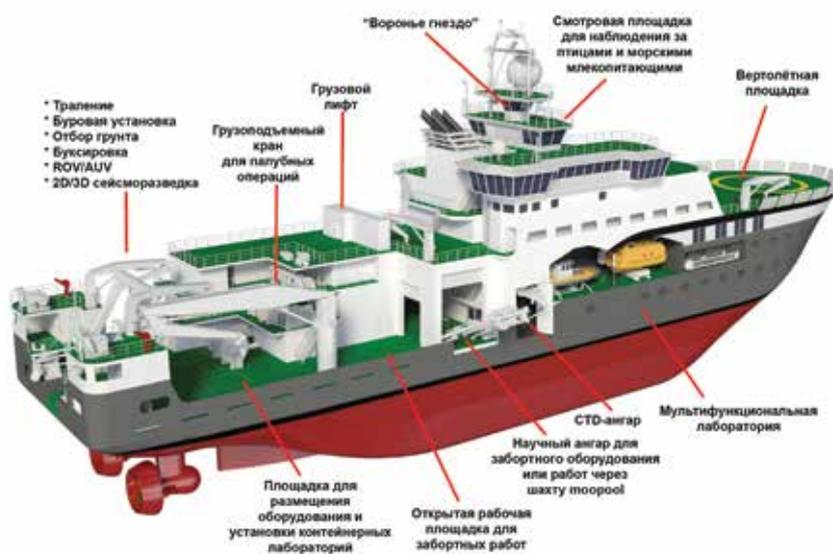
**Рисунок 6.** Расположение основных функциональных устройств на компьютерной модели НИС «Kronprins Haakon»
