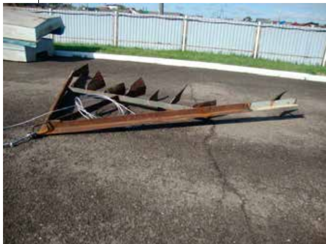
Рисунок 1. Рыхлитель ила конструкции Сладковского рыбхоза. Длина остро отточенной грани агрегата 3 м
