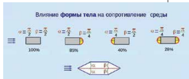
Рисунок 10. Влияние формы тела на величину силы сопротивления (интернет, свободный доступ)
